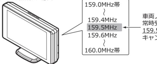
※キャンセルした159.5MHz以外の159.0～159.4MHz、159.6～160MHzを受信するとキャンセルされずに警報を行います。
