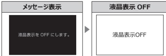
※液晶画面をタッチして一時的に（約 15 秒間）画面表示されている間に再度同様の操作を行うと、メッセージ表示後に液晶表示が ON になります。
