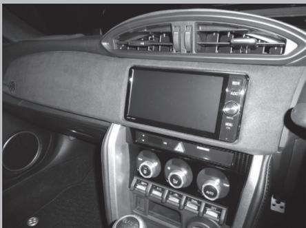
86/BRZのマイナーチェンジ後(16/08以降)の車両はグレードにより助手席側のパネルがナビ枠部のパネルと一体になっており、メーターパネルを取り付ける場合別途ナビ枠部のパネルが必要となります。下記品番のナビ枠部の純正パネルをディーラーにてお買い求めください。
