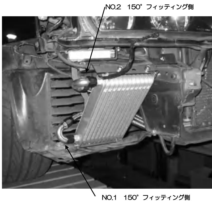
⑪稼動部分等に干渉が無いようフィッティングの位置を調整して、センター bolt、フィッティングを本締めします。
