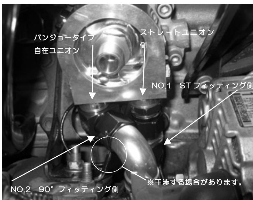
⑦クーラーホースを下図を参考にオルタネータ下側へ出し、左フェンダー内方向へ通します。
