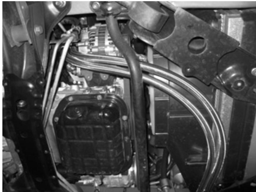
車体フレームとテンションロッドブラケットの間を通し、車両左側ヘッドライトユニットの下側へホースを通します。
