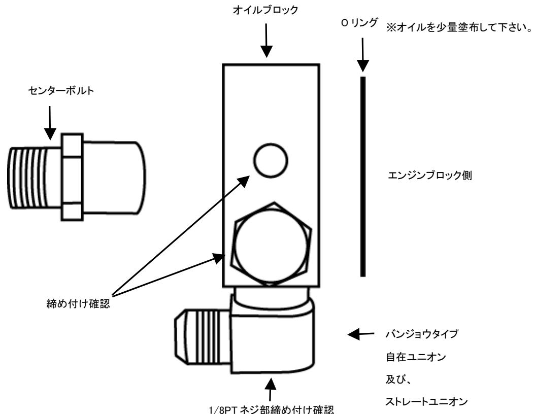
⑥オイルブロックへクーラーホース No.1 ST フィッティング側、No.2 の 90° フィッティング側を取り付けます。
