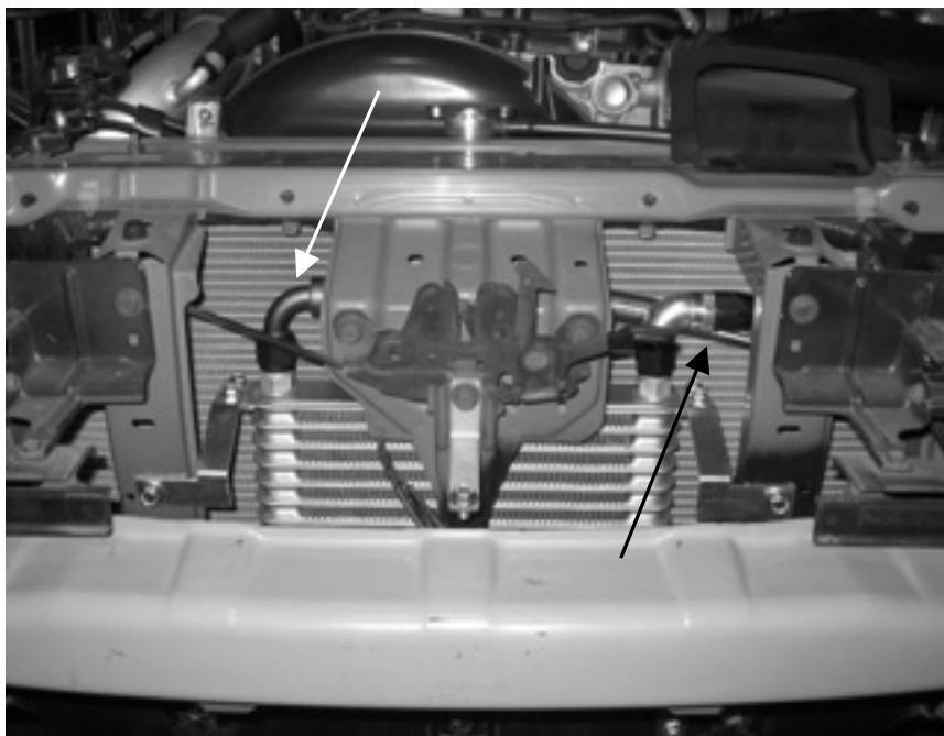
⑨稼動部分等に干渉が無いようフィッティングの位置を調整して、センター bolt、フィッティング、自在ユニオンを本締めします。
