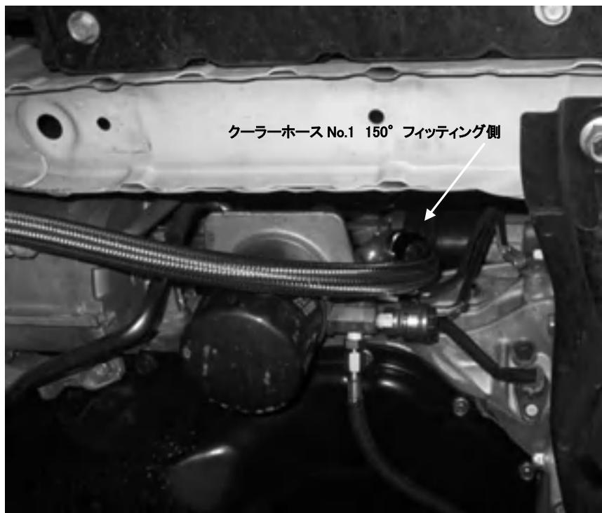
④クーラーホース No.2 90° フィッティング側を、前に取り付けた純正オイルクーラー ストレートユニオンへ接続します。
