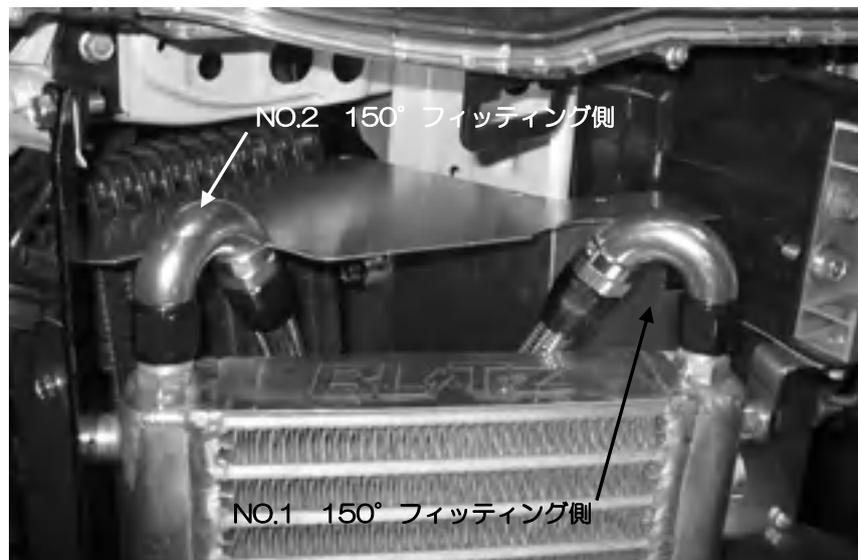
⑨稼動部分等に干渉が無いようフィッティングの位置を調整して、フィッティングを本締めします。
