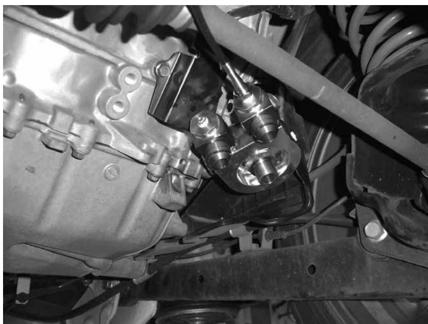
オイルブロック取付後
