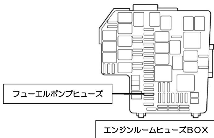
ポンプヒューズを戻し、エンジンを始動します。各部に漏れが無い点検を行って下さい。
