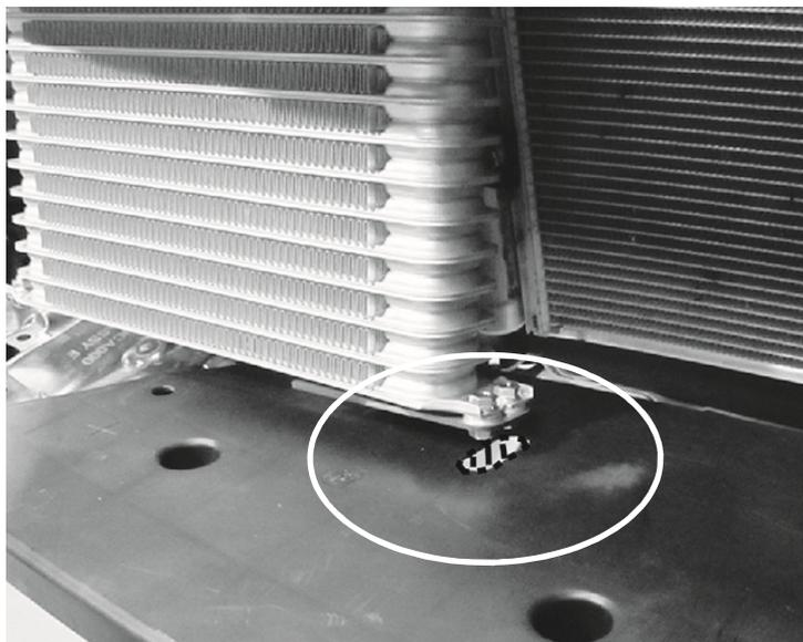
※エアガイド LH を取り付ける際、ホースが通る部分をカット加工します。
