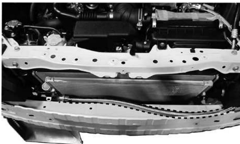
⑱稼動部分等に干渉が無いようフィッティングの位置を調整して、センターボルト、自在ユニオン、フィッティングを本締めします。
