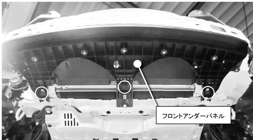
⑧ホーンへ接続されているハーネスを切り離し、ホーンをステアから切り離します。車両に残ったステアは使用しません、車両から取り外しておきます。
