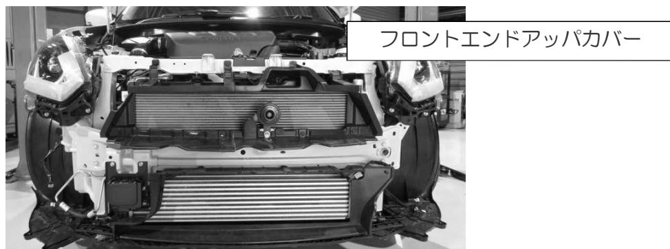
⑤写真を参考に、フロントバンパメンバにフランジボルト M6×16 2個、フランジナット M6 2個、φ16ワッシャー 2個を使用してステーNo.1とステーNo.2を仮止めします。
