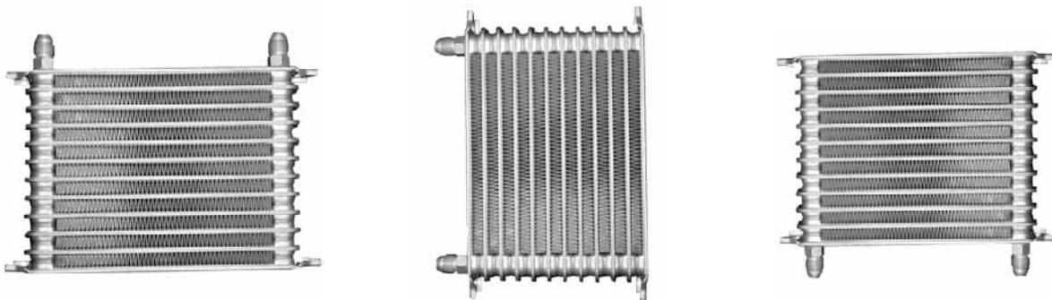
オイルクーラーコアの取り付け、コアの中の空気が、オイルが流れたときに残らないように取付てください。下向きに取り付けた場合、オイルクーラーコア内に空気が残り、コアの半分しかオイルが流れないと恐れがあり、十分に性能を発揮できない可能性がありますので注意して下さい。
