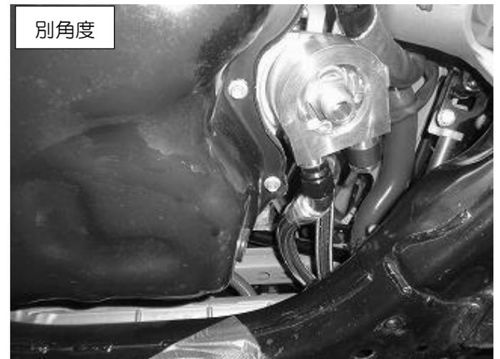
◎稼動部分等に干渉が無いようフィッティングの位置を調整して、センターボルト、自在ユニオン、フィッティングを本締めします。ホースの取り回しは下写真を参考してください。
