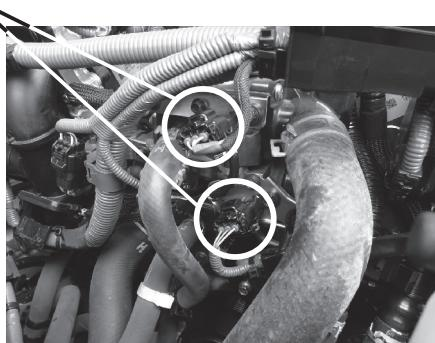
※ サブ側圧力センサーは 2 つあります。分岐ハーネスを使用し、本体ハーネスの 4 極白コネクタに接続してください。
