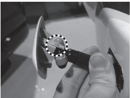
ヘッドライトウォッシャーカバーを引き出し、ツメを外してカバーを取り外してください。
