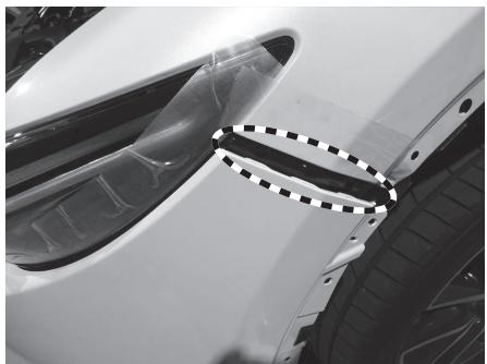
フェンダー、ヘッドライトにしっかりと養生し、フェンダーとのかん合を外してフロントバンパーを車両前方に外してください。
