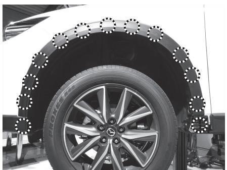
フロントバンパーのフェンダー側左右とアンダー側のクリップ・ビスを取り外してください。
