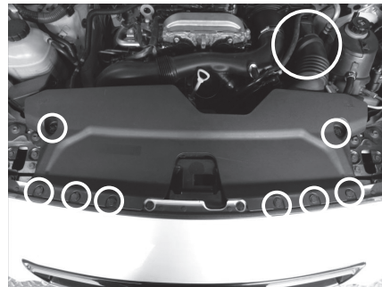
クリップ 8 か所、ダクト接続部 1 か所
