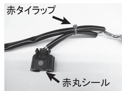
サブ側圧力センサーハーネス
