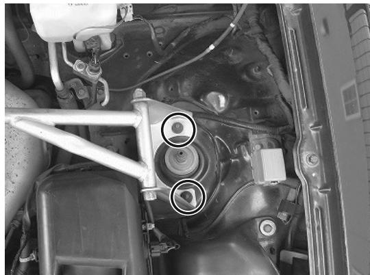
2. ストラットバーシャフトのボルト、ナットを仮締めし車両に仮合わせします。ストラットバーシャフトのロゴ向きを間違えないように取り付けてください。
