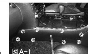
図A-1 かん合 インストルメントフィニッシュパネルエンドLH
