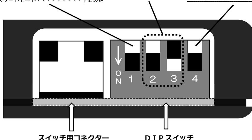
**注** DIPスイッチ2,3の位置が上図のように設定されているか必ず確認して下さい。
