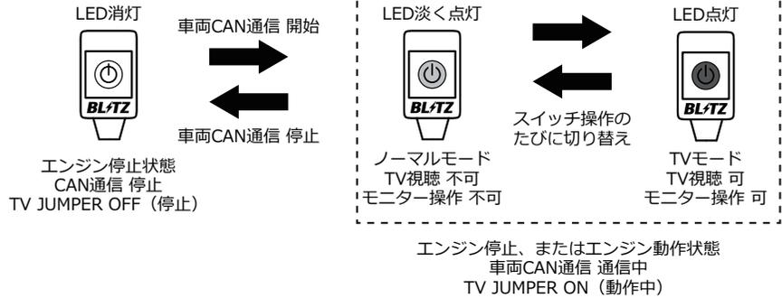
**注意** 本製品が適合する車両はエンジンを停止しても車両のCAN通信がすぐに停止しないため、コンパクトスイッチのLEDはしばらく点灯し続け、コンパクトスイッチが操作できる状態のままとなります。車両をドアロックして一定時間が経過するか、ドアの開閉、ペダルや車内のスイッチ類の操作が一定時間行われなければ、車両のCAN通信が停止し、コンパクトスイッチのLEDも消灯します。また、コンパクトスイッチのLEDが消灯状態でエンジンを始動していても、車両のドアロックの解除やドアの開閉、ペダルや車内のスイッチ類の操作が行われると、車両のCAN通信が開始され、コンパクトスイッチのLEDが点灯しますが、製品の不具合ではありません。
