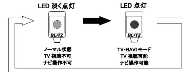
※コンパクトスイッチアダプターを取り付けた際のスイッチイラスト図になります。
