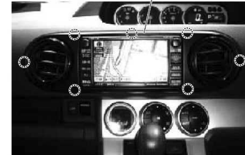
図A インストルメントクラスタフィニッシュパネル
