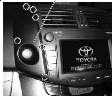
図A インストルメントクラスタフィニッシュパネルCTR No.2
