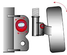
偏心カムを採用した車種別ブラケットの穴形状とそれに合わせた専用のボルトを容易に動かせるため、簡単且つワイドレンジでキャンバー調整が可能になります。ブラケット部
