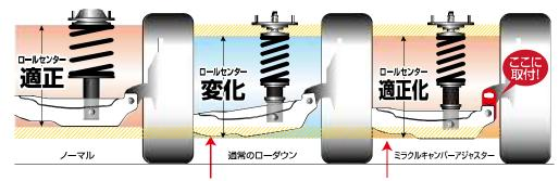
車高ダウンによってロアアームの 位置も下がり、ロールセンターも 下がります。 ラテラルリンクの位置を適正化します。 (ロールセンターを上げる)
