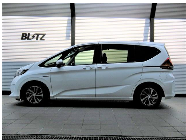
フロント:-48mm ダウン / リア:-40mm ダウン
