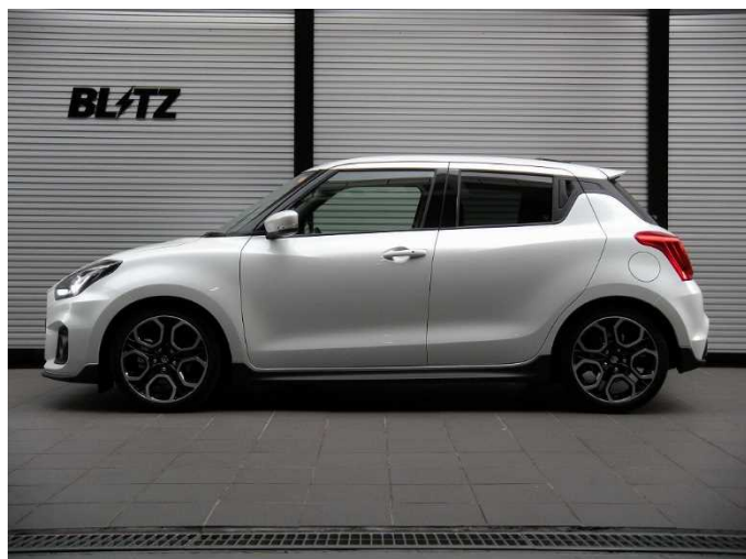
フロント:-33mm ダウン / リア:-32mm ダウン
