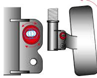
偏心カムを採用した車種別ブラケットの穴形状とそれに合わせた専用のボルトを容易に動かせるため、簡単且つワイドレンジでキャンバー調整が可能になります。ブラケット部分で0度~5度まで調整可能となります。
