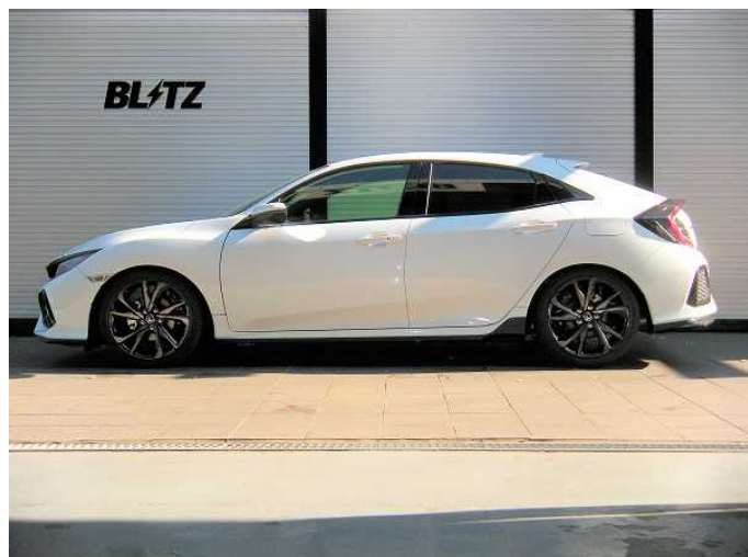
フロント:-36mm ダウン / リア:-45mm ダウン
