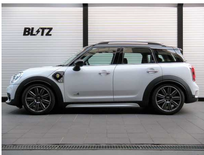
フロント:-44mm ダウン / リア:-60mm ダウン
