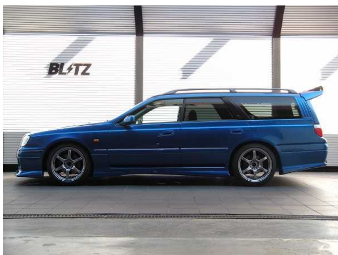
フロント:-40mm ダウン / リア:-25mm ダウン
