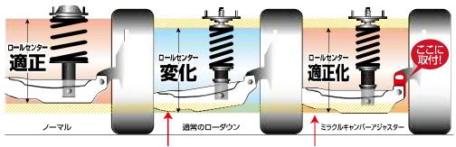
車高ダウンによってロアアームの 位置も下がり、ロールセンターも 下がります。 ラテラルリンクの位置を適正化します。 (ロールセンターを上げる)
