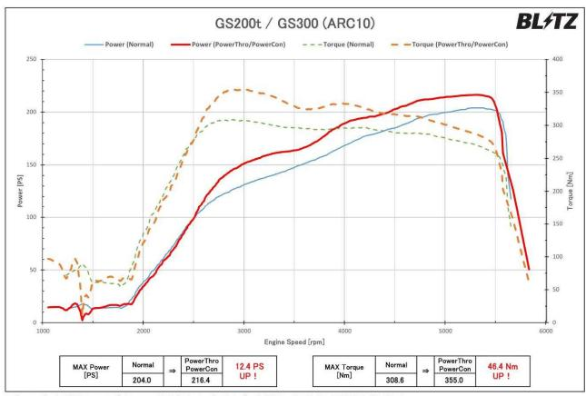
※グラフ、データは弊社シャーシダイナモでの計測事例です。車両ならびに装着部品、燃料などにより個体差があります。
