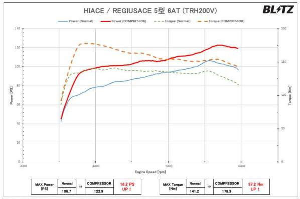
※グラフ、データは弊社シャーシダイナモでの計測事例です。車面ならびに装着部品、燃料などにより個体差があります。
