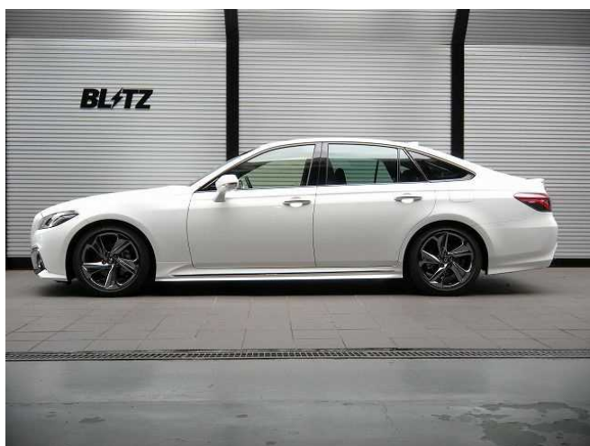
フロント:-21mm ダウン / リア:-18mm ダウン
