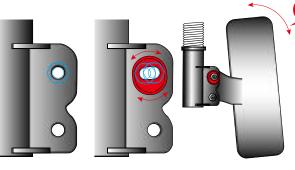
偏心カムを採用した車種別ブラケットの穴形状とそれに合わせた専用のボルトを容易に動かせるため、簡単且つワイドレンジでキャンバー調整が可能になります。ブラケット部分で0度~5度まで調整可能となります。
