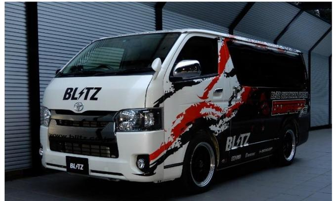
※ フロントの車高はトーションバーを調整して車高を下げています。
