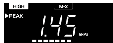
チャンネル【HIGH M-2】 ピークホールド表示画面
