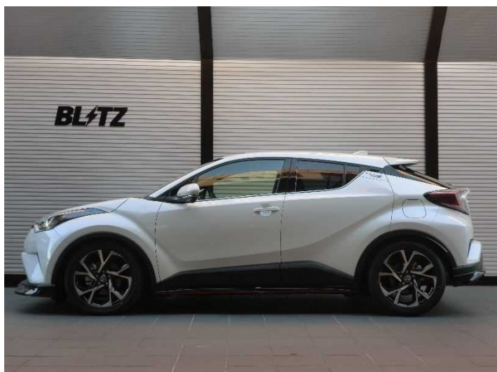
フロント:-33mm ダウン / リア:-54mm ダウン
