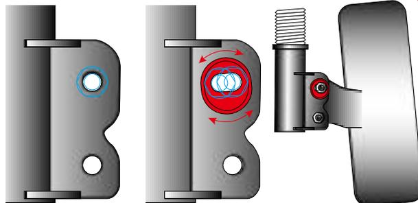
偏心カムを採用した車種別ブラケットの穴形状とそれに合わせた専用のボルトを容易に動かせるため、簡単且つワイドレンジでキャンバー調整が可能になります。ブラケット部分で0度~-5度まで調整可能となります。
