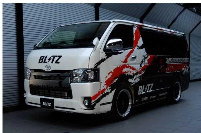
※ フロントの車高はトーションバーを調整して車高を下げています。
