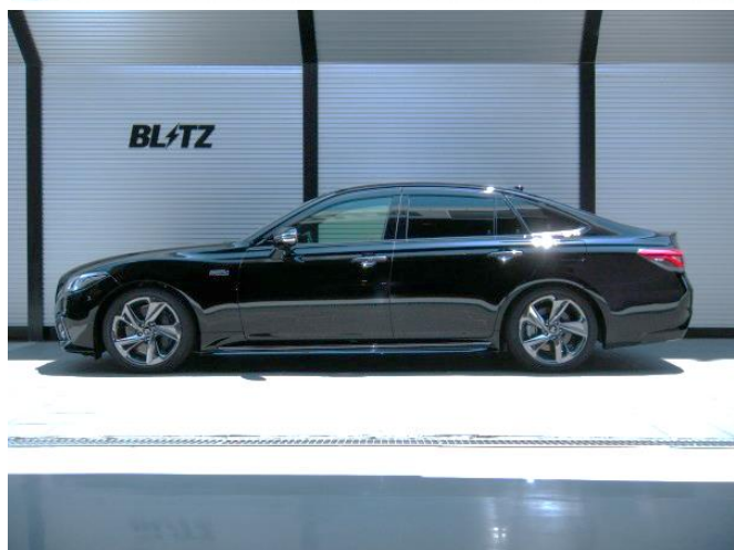
フロント:-23mm ダウン / リア:-15mm ダウン
