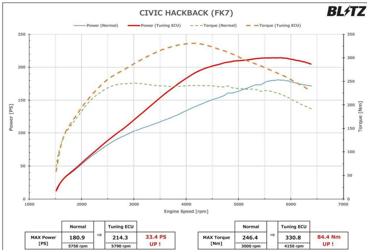
※グラフ、データは弊社シャーンダイナモでの計測事例です。車両ならびに装着部品、燃料などにより個体差があります。
