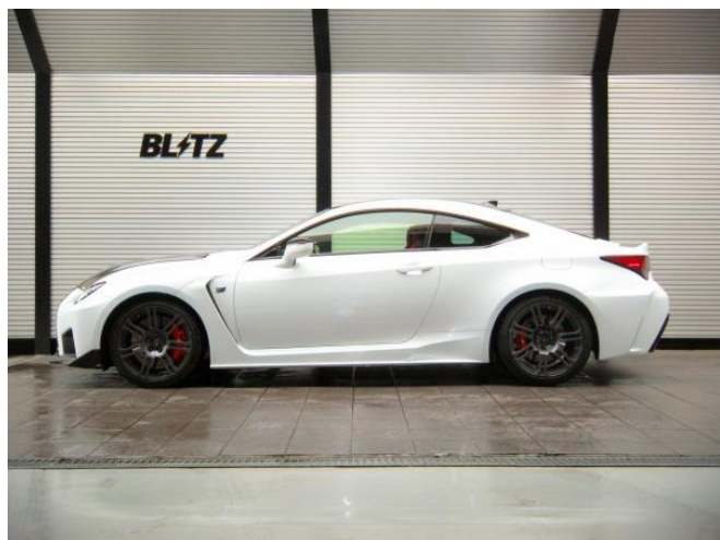
フロント:-24mm ダウン / リア:-18mm ダウン
