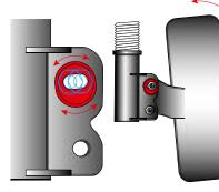
偏心カムを採用した車種別ブラケットの穴形状とそれに合わせた専用のボルトを容易に動かせるため、簡単且つワイドレンジでキャンバー調整が可能になります。ブラケット部分で 0 度~-5 度まで調整可能となります。
