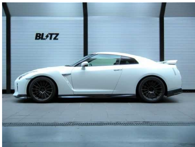
フロント:-8mm ダウン / リア:-10mm ダウン
