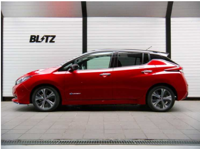
フロント:-32mm ダウン / リア:-23mm ダウン
