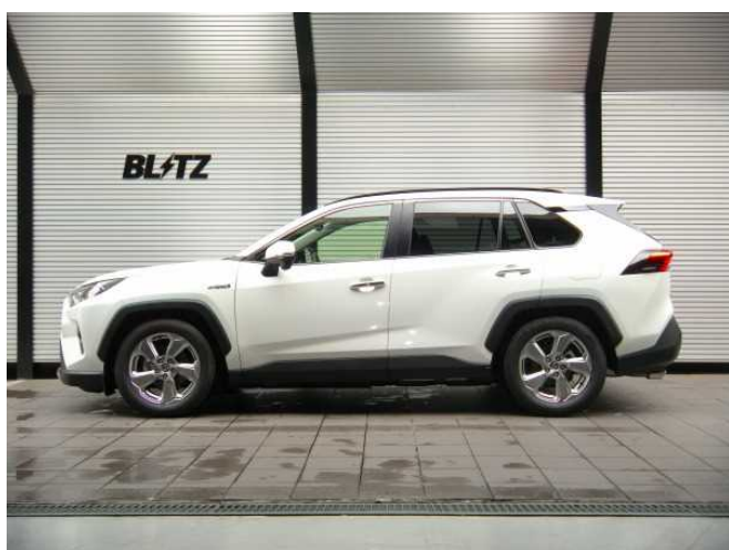
フロント:-45mm ダウン / リア:-46mm ダウン
