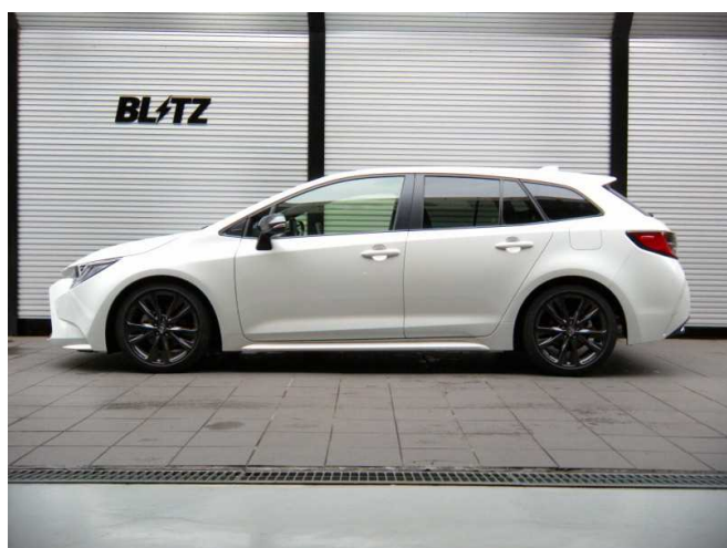
フロント:-33mm ダウン / リア:-26mm ダウン
