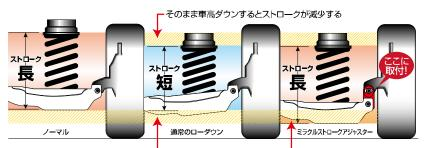
車高ダウンによってロアアームの 位置も下がり、ロールセンターも 下がります。 ラテラルリンクの位置を適正化する (ロールセンターを上げる) とともに ストローク量も確保します。
