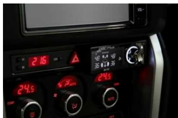
新開発 2.5 インチ VA 液晶搭載コントローラー
