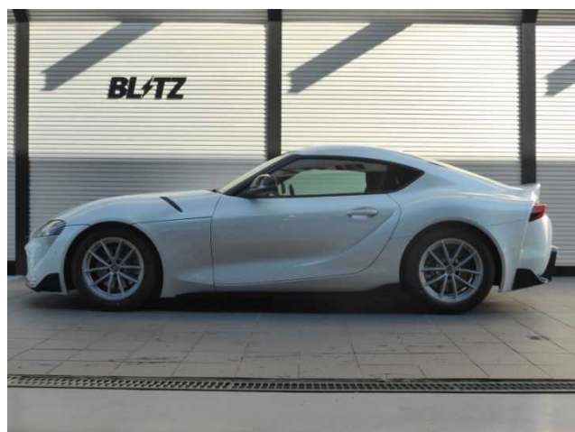
フロント:-28mm ダウン / リア:-18mm ダウン
